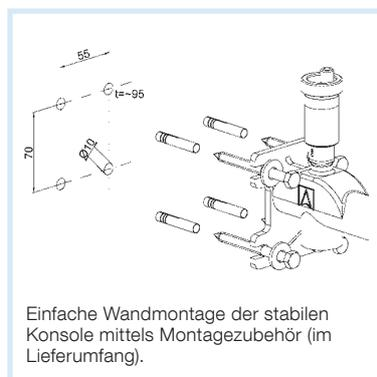
Einfache Wandmontage der stabilen Konsole mittels Montagezubehör (im Lieferumfang).
