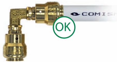
5. Die optimale Einstecktiefe des Rohres wurde fachgemäß durchgeführt, die Verbindung ist einsatzbereit
