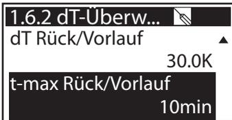
Das zweite Fehlerkriterium definiert sich wie folgt: Mit >dT Rück/Vorlauf< wird ein Temperaturunterschied zwischen Rücklauf und Vorlauf, mit >t-max Rück/Vorlauf< die Zeitspanne dazu festgelegt.
