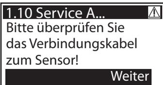
Zur Fehlerfindung gibt hier der Regler den Hinweis, das Verbindungskabel zu überprüfen.
