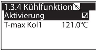
Hier wird die Kollektorkühlung aktiviert: bei Erreichen der Kollektortemperatur >T-max Koll1< läuft die Solarkreispumpe bis die Speichergrenztemperatur erreicht ist.
