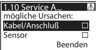
Bei dieser Störung werden folgende Ursachen angenommen: >Kabel/Anschluss< oder >Sensor< - den ersten Menüpunkt anwählen und mit >OK< bestätigen.
