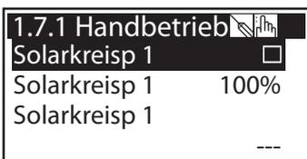
Im Handbetrieb können die einzelnen Ausgänge zu Testzwecken aktiviert werden, z.B. um zu überprüfen, ob eine Pumpe ordnungsgemäß funktioniert.
