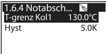
Mit >T-grenz Kol1< wird die Solarkreispumpe abgeschaltet, um eine Zerstörung zu verhindern.
