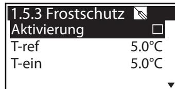
Bei Einsatz von Frostschutzmitteln kann Art und der Anteil eingegeben werden, die Frostschutztemperatur wird automatisch berechnet.
