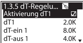
Wurden unter >1.3.7 Ausgangsparameter< Regelungsalgorithmen mit >dT< festgelegt, können die entsprechenden Ausgänge hier konfiguriert werden.
