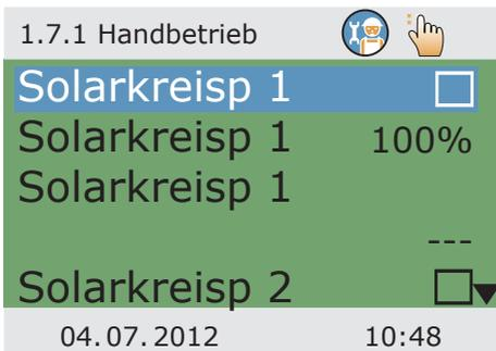
Im Handbetrieb können die einzelnen Ausgänge zu Testzwecken aktiviert werden, z.B. um zu überprüfen, ob eine Pumpe ordnungsgemäß funktioniert.
