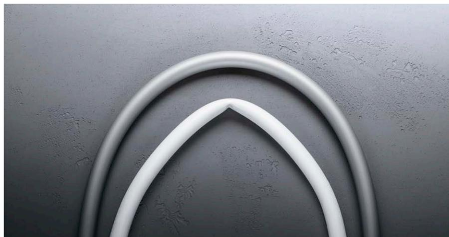
Vergleich Raxofix-Rohr 20 x 2,8 mm
