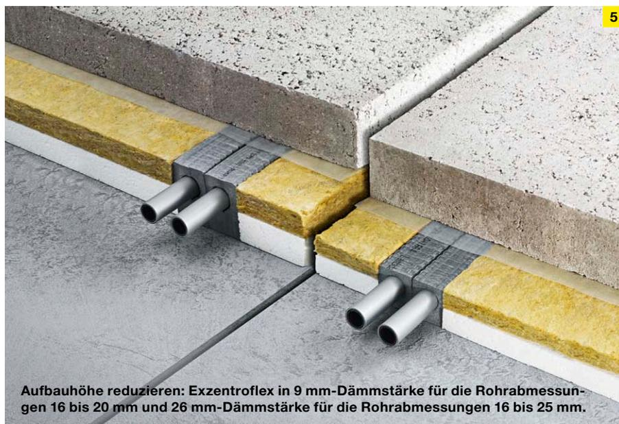
Aufbauhöhe reduzieren: Exzentroflex in 9 mm-Dämmstärke für die Rohrabmessungen 16 bis 20 mm und 26 mm-Dämmstärke für die Rohrabmessungen 16 bis 25 mm.
