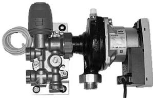
Kleinflächenregelstation mit Umwälzpumpe für den Betrieb von Flächenheizungen bis ca. 40 m<sup>2</sup> in Verbindung mit Radiatoren. Anschluss von max. 2 Fußbodenheizkreisen über T-Anschluss-Stücke (Zubehör) möglich.
